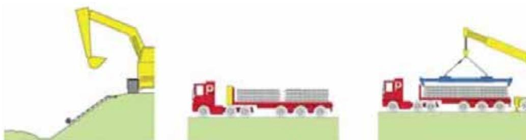
Una vez preparado el talud se coloca un geotextil para evitar el “lavado” del mismo. La colocación de las mantas se hace con la ayuda de una grúa, después de posicionadas se deben fijar al terreno en ambos extremos. Una vez colocadas las mantas, el sistema debe acabarse rellenando los huecos con arena y tierra, lo cual incrementa enormemente la estabilidad.
